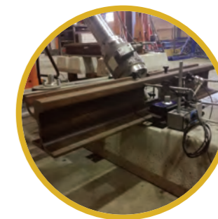
Université de Louvain, réalisation d'essais normalisés de la selle. Essais aux normes européennes : 3 millions de cycles, 5 tonnes à 45°
