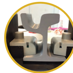
Réalisation d'un prototype d'une selle adaptée au rail nantais - Impression 3D
